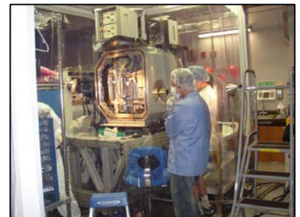
IRCS の実験中。ホコリが入らないようにピニールの中で作業をしています。
