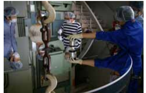
真空蒸着装置に入れ、アルミニウムを蒸発させて薄く貼り付けます。写真は、再メッキされた鏡の反射率を測定しているところ。
