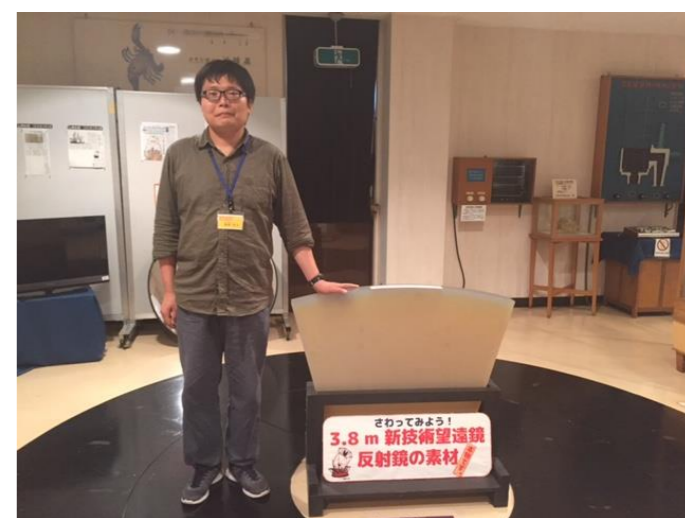
図4. 反射鏡の一部。これを18枚並べて一枚にします
