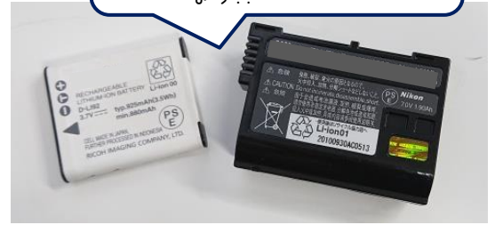
写真1 デジタルカメラのリチウムイオン電池
