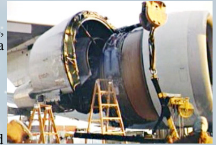
Avión comercial de pasajeros de KLM dañado por la ceniza volcánica.
