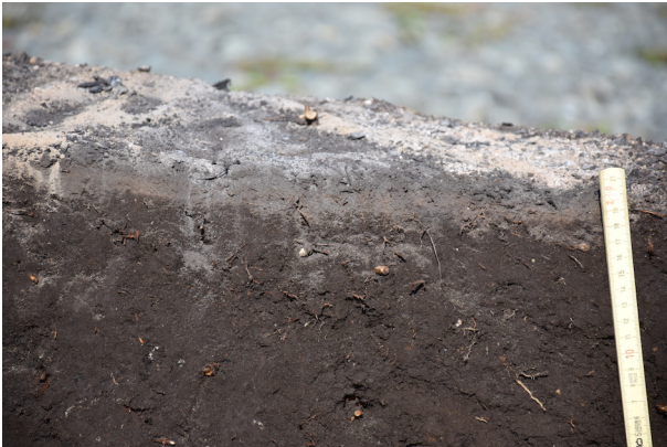
図14 実験Aの焚き火中央部付近の拡大図。 表層付近の黒色層の下位に色の灰色の層がある。表層の右側には、ベージュに変色した部分が認められる。それより下位の部分は、草木の根は焦げていない。
