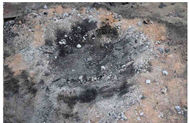
図11 焚き火終了後の状態（実験B）．焚き火の周縁にベージュに変色した堆積物が認められる．
