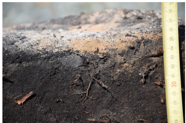
図17 実験Bの焚き火中央部付近の拡大図。 表層のBベージュの層の下位に灰色の層がある。
