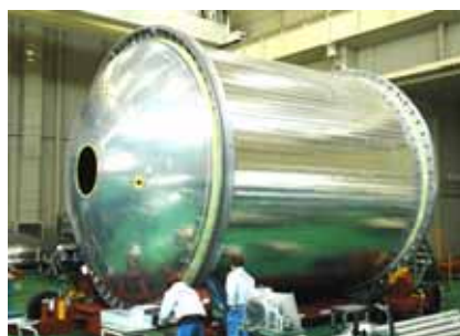
図2 完成した大型液体酸素タンク供試体(直径5.2m)
