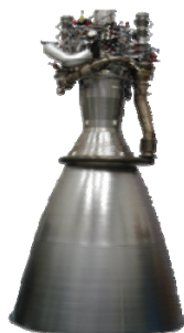
実機型アブレータ式エンジン(LE-8)
