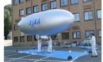
建物に近接した場所で発進・回収が3人で可能なことを実証。
