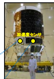
HTV-PFT音響試験 (平成20年9月)
