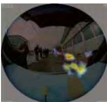
宇宙観測用に開発した軟ガンマ線観測装置を応用した放射性物質分布可視化装置「超広角コンプトンカメラ」の実証実験結果(2012年3月29日報道発表) *ASTRO-Hに搭載予定
