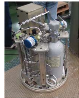
図:小型姿勢制御装置の外観(S-310用装置)
