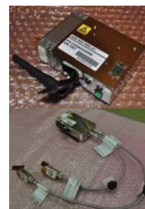
子機A(センサ内臓型): 温度・湿度・照度・圧力・人感センサを内部に有する。
