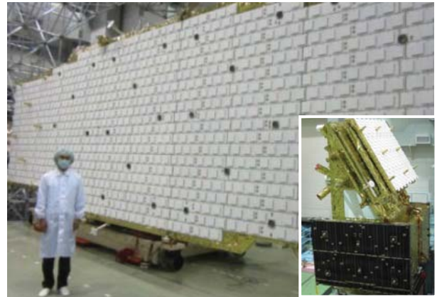
ALOS-2 SARアンテナの試験状況
