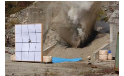
図:はやぶさ2衝突装置 飛翔性能確認試験衝突装置から射出される飛翔体について、命中精度等所定の機能実証が得られた。
