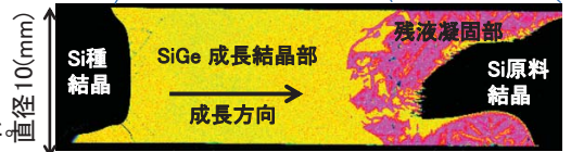
図: Hicari宇宙実験で育成したSiGe結晶の外観(上)と、SiGe結晶中のGe濃度分布(下、濃度分布を色の違いで表現) 左から右に結晶が成長し、地上実験では得られない均一組成が得られた。
