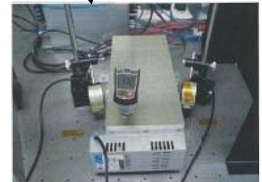
光アンプ試作器(気流計測ライダーの一部)
