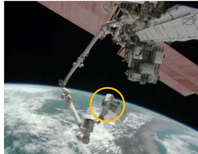
船外活動(EVA)を行う米国宇宙飛行士をロボットアームの先端に乗せ、熱制御系ポンプを交換を支援
