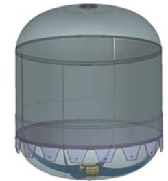
複合材推薬タンク(実機イメージ)
