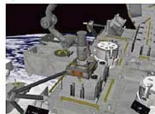
3 「きぼう」のロボットアームを地上から操作し、「きぼう」の船外部分にある手すりに取り付ける。
