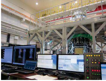
図1 2段ノズル伸展試験
