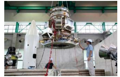
図4 PBS(ポストブーストステージ)分離衝撃試験
