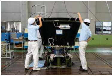
図1 2段ノズル伸展試験
