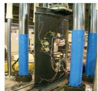
宇宙輸送本部・複合材ロケット構造強度試験 (圧縮試験。点検口周囲のひずみ分布を計測)
