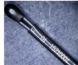
リード形サーミスタ （写真の1辺が約10mm）
