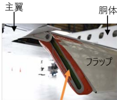
フラップ作動用の溝 想定外の騒音が発生したが 原因解明と対策設計が完了
