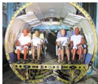
YS-11実機を用いた落下衝撃試験
