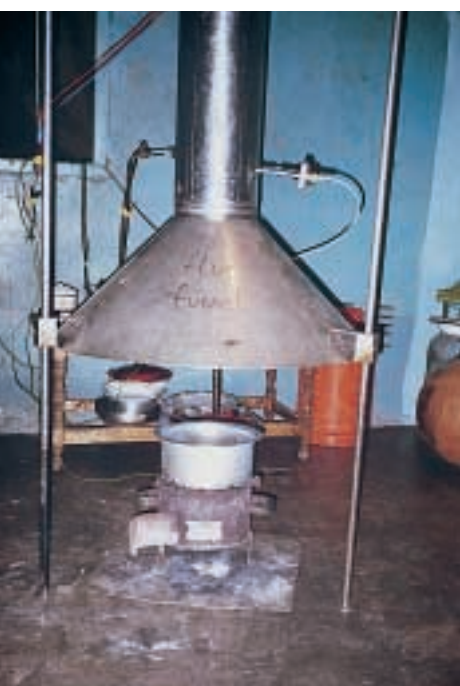
Abb. 13. Über der Kochstelle wird ein künstlicher, schwach ziehender Kamin aufgebaut. Die Abluft des Kochfeuers wird über Leitungen zu den Messgeräten geführt, die auf einem kleinen Lieferwagen aufgebaut sind. Wir versuchen, den Kochablauf möglichst wenig zu stören.
