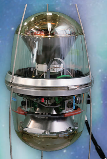
従来の光検出器をもとに、石原教授が中心となってICEHAPが独自開発したD-Egg
