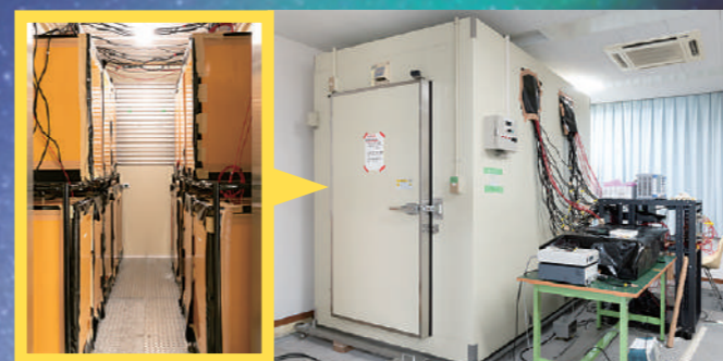
D-Eggが設置されるのは南極の氷河下のため、冷凍庫内で性能試験を行っている
