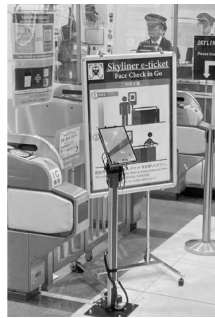
改札に設置したタブレット端末で顔認証する(京成上野駅)
