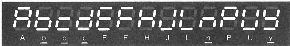
図 3 7セグメント LED で表示したアルファベット(下線は小文字を示す)
