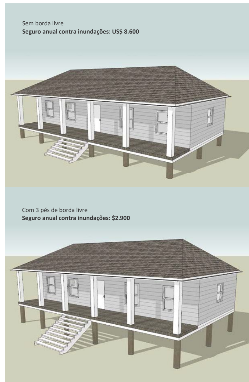
Figura 5-1. Neste exemplo, adicionar uma pequena quantidade de altura tem muito pouco efeito sobre a aparência de uma casa, mas resulta em uma economia substancial de seguro contra enchentes. Imagem da MassCZM modificada, mais informações disponíveis em: www.mass.gov/service-details/using-freeboard-to-elevate-structures-above-predicted-floodwaters .
