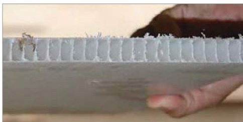
Figura 4-15. O painel favo de mel de plástico tem muitas vezes a resistência da madeira compensada normal e não empenam ou apodrecem. É fácil de cortar e perfurar e, o que é importante, é leve quando comparado ao compensado normal. A grande desvantagem é a falta de disponibilidade desse material nas lojas de ferragens locais.
