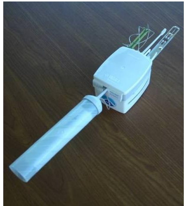
The RS-92 radiosonde.
