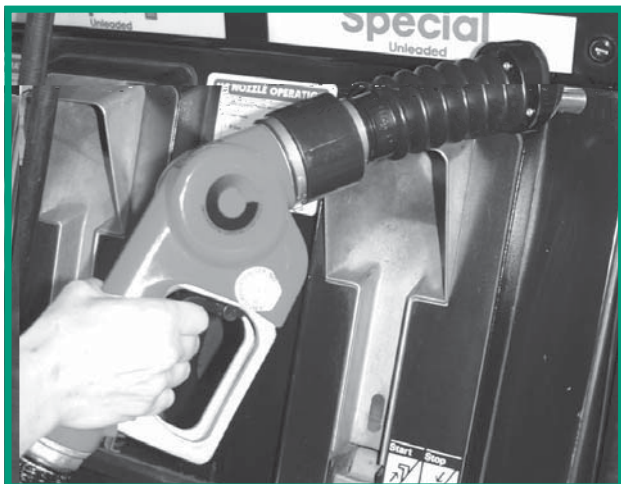
《空氣清潔法案》規定某些區域的加油站，必須安裝蒸氣回收噴嘴。這種氣泵噴嘴可在民眾加油時，減少釋放到空氣中的汽油蒸氣。
