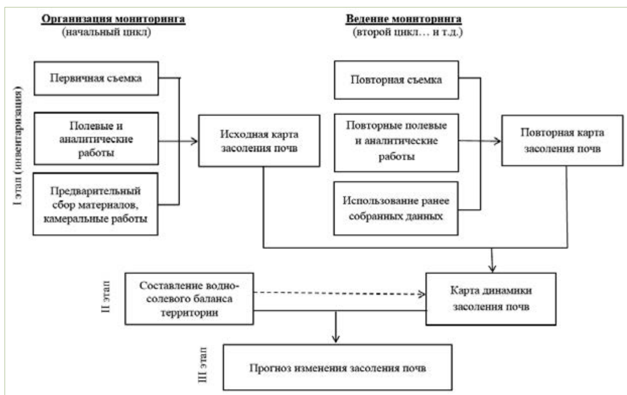
Рис. 12.1. Общая схема дистанционного мониторинга засоления орошаемых почв
