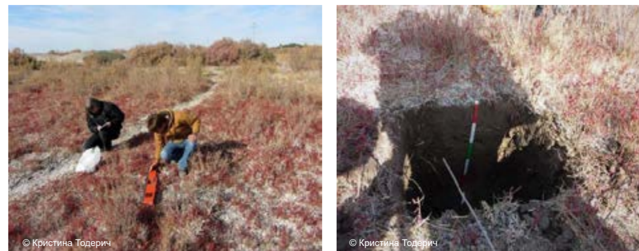
Рисунок 13. Полевая съемка с помощью метода электромагнитной индукции прибором EM38 на засоленных массивах Каракалпакстана, Узбекистан
