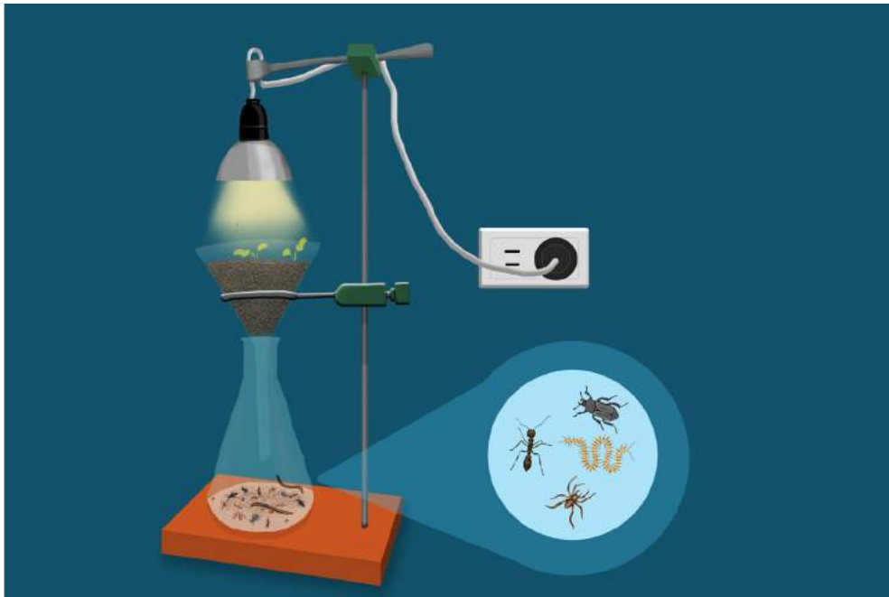
Ilustración 15. Trampa de luz: dispositivo para la recolección de mesofauna del suelo
