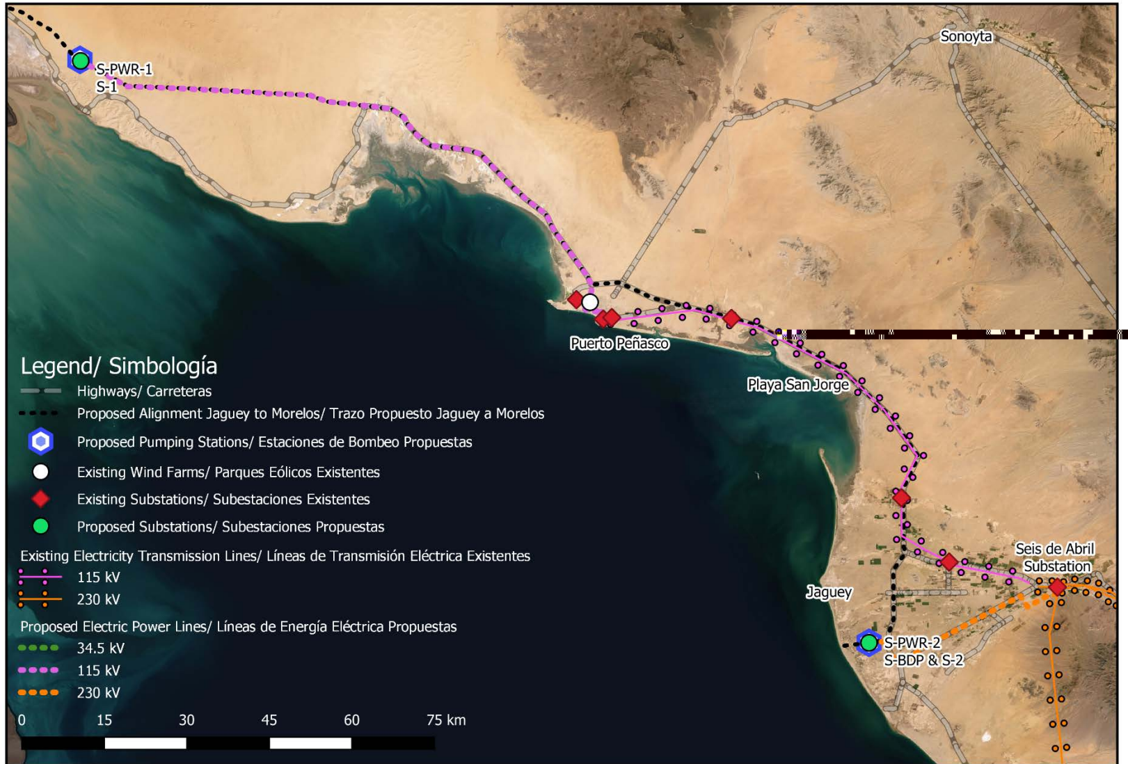
Figure/Figura 19 Opportunity 1 – Proposed electrical power design Oportunidad 1 – Diseño de energía eléctrica propuesto
