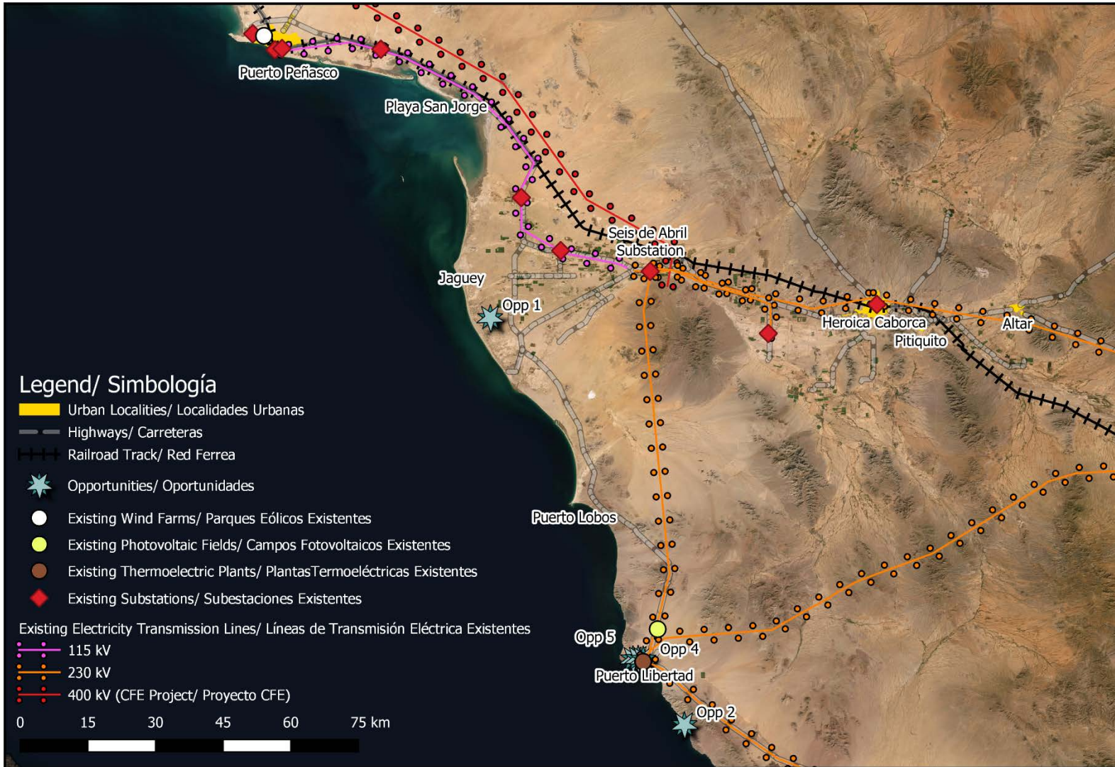
Figure/Figura 18 Existing electrical infrastructure in the study area Infraestructura eléctrica existente en el área de estudio
