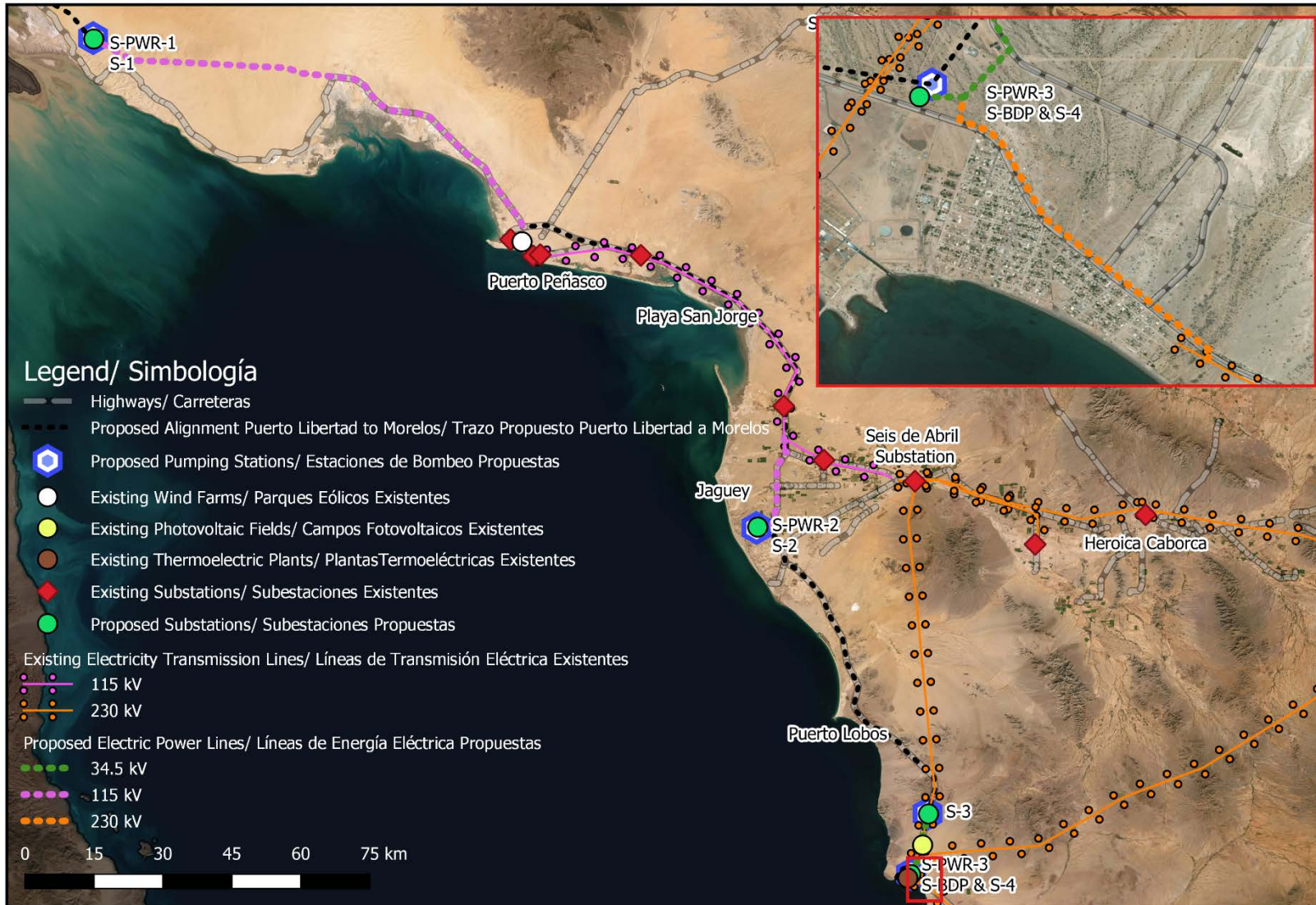
Figure/Figura 54 Opportunity 5 – Proposed electrical power design Oportunidad 5 – Diseño de energía eléctrica propuesto
