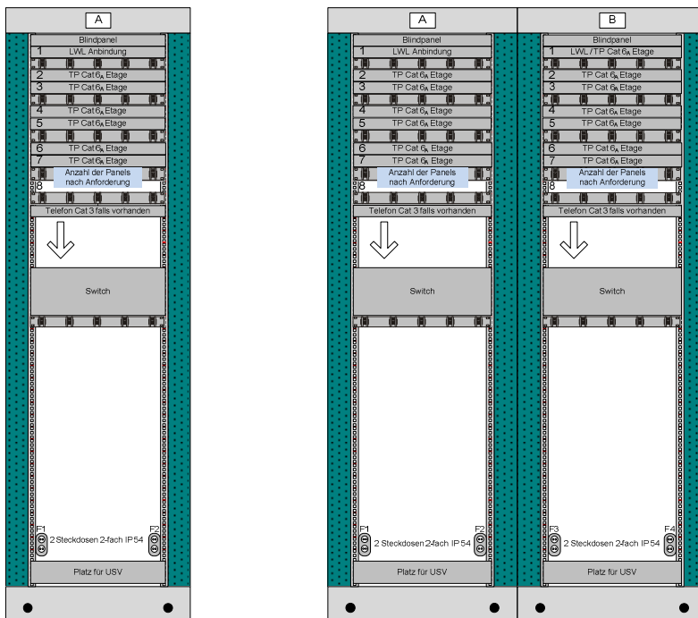
Beispiele für ein oder zwei 19" Standverteiler (schematisch)
