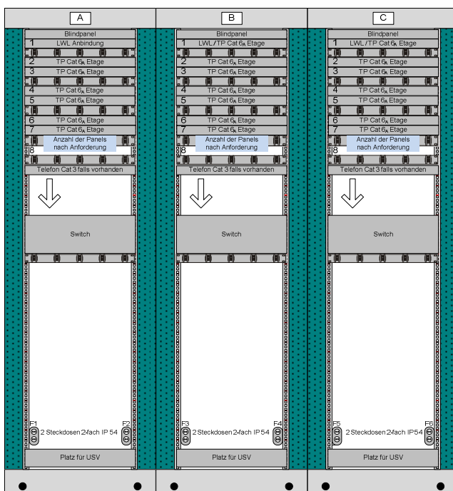
Beispiel für drei 19" Standverteiler (schematisch)
