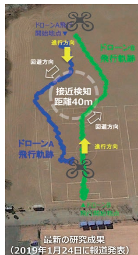
図3 自律飛行制御の実証実験結果（2台のドローンのニアミス回避）
