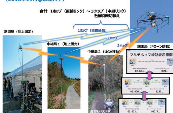
図1 産業技術総合研究所と共同で実施したコマンドホッパーによるマルチホップ伝送実験の様子
