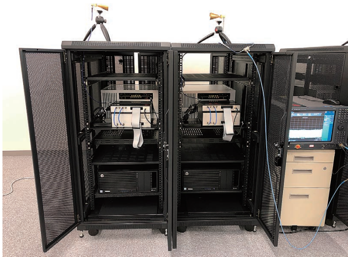
5Gシステム協調制御の性能評価のために試作した実験用ミリ波帯自営マイクロセル（小さいエリア）基地局
