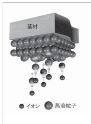
図3 表面反応の模式図 Fig.3 Schematic of surface reaction
