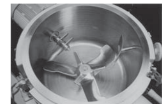
図1 ユニバーサルミキサ混合槽内部、3枚羽根のアジテータと槽壁のチョッパ Fig.1 Inner view of Universal mixer, 3-blades agitator and chopper on side wall
