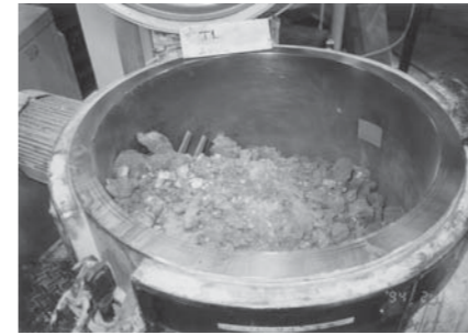
図4 ブレーキコンパウンド原料仕込み時(型式:EM100B) Fig.4 Charge of raw material for brake compound
