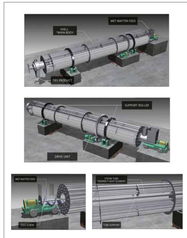
図10 スチームチューブドライヤーの鳥瞰図 Fig.10 Bird's eye view of steam tube dryer
