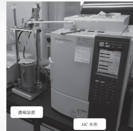
図1 消化ガス分析用ガスクロマトグラフィー Fig1 Gas chromatography for digestion gas analysis
