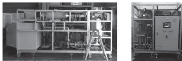
(a) D200型 (b) D50型 図10 渦流式微粒子晶析装置の外観 Fig.10 Picture of vortex flow crystallizer
