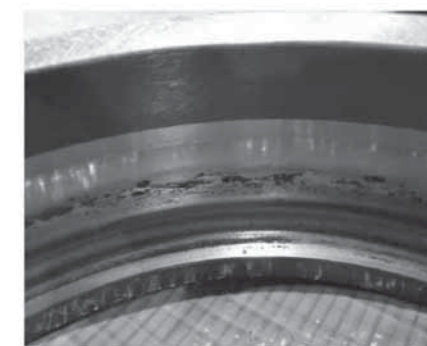
図2 分解して損傷が確認されたベアリング写真 Fig.2 Damaged Bearing
