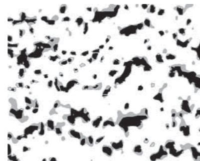
図5 セマンティックセグメンテーションによる間隙認識 Fig.5 Prediction results of semantic segmentation for area of floc gap
