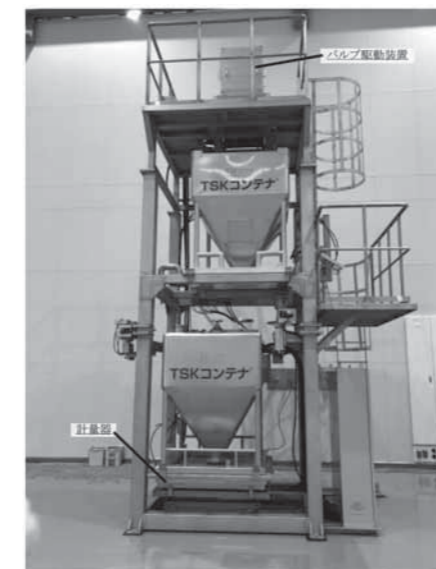
図2 計量ステーション画像(コンテナ to コンテナ計量テスト機) Fig.2 The weighing station for test
