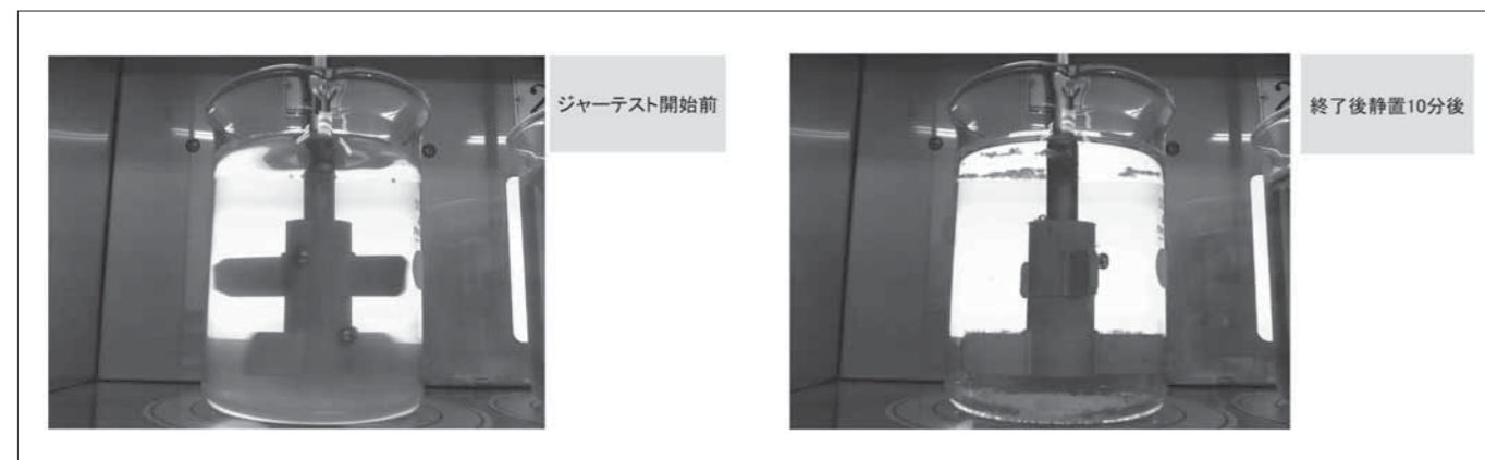
図13 ジャーテスト開始前と静置10分後 Fig.13 Before jar test and 10 min after stopping agitation
