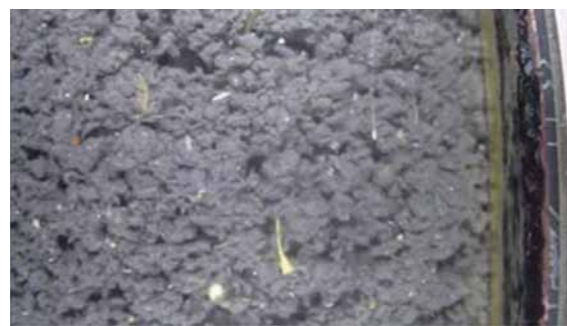
図2 凝集混和槽で撮影したフロック画像 Fig.2 Image of flocs in the flocculation tank
