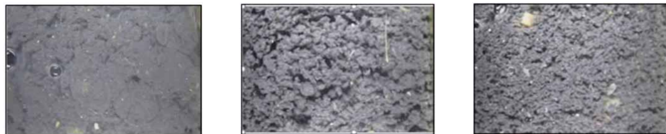
図3 高速ミキサー回転数の違いによるフロック状態の変化 Fig. 3 Differences in flocs at different rapid mixer speeds
