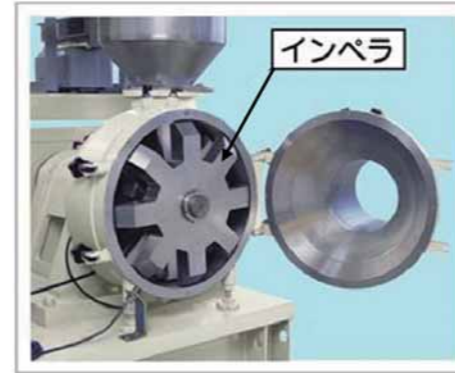
図4 サイクロンミル 分解時の様子 Fig.4 State of Cyclone Mill when open
