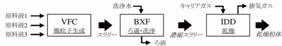
図7 VFC-BXF-IDDプロセスのブロックフロー Fig.7 Block flow diagram of VFC-BXF-IDD combination process
