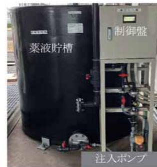
図4 実証装置 Fig.4 Demonstration device
