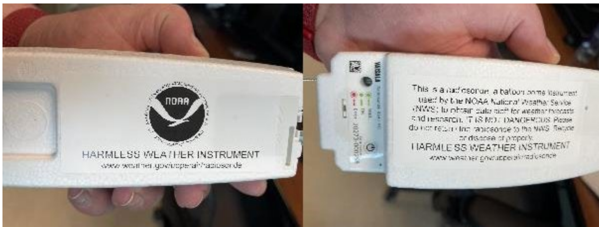
Figure A-2: Upper Air Radiosonde (Vaisala)
