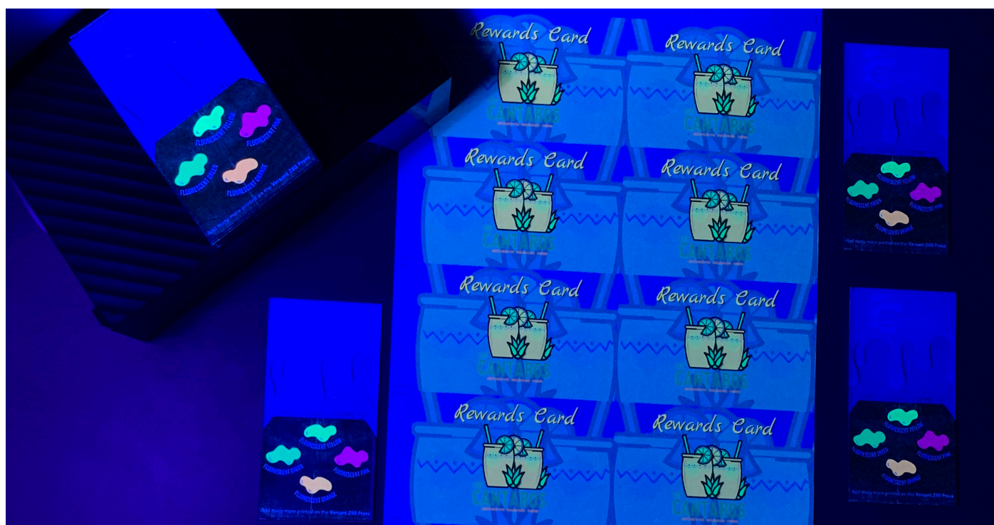
Le toner fluorescent brille d'une véritable fluorescence sous une lumière noire.
