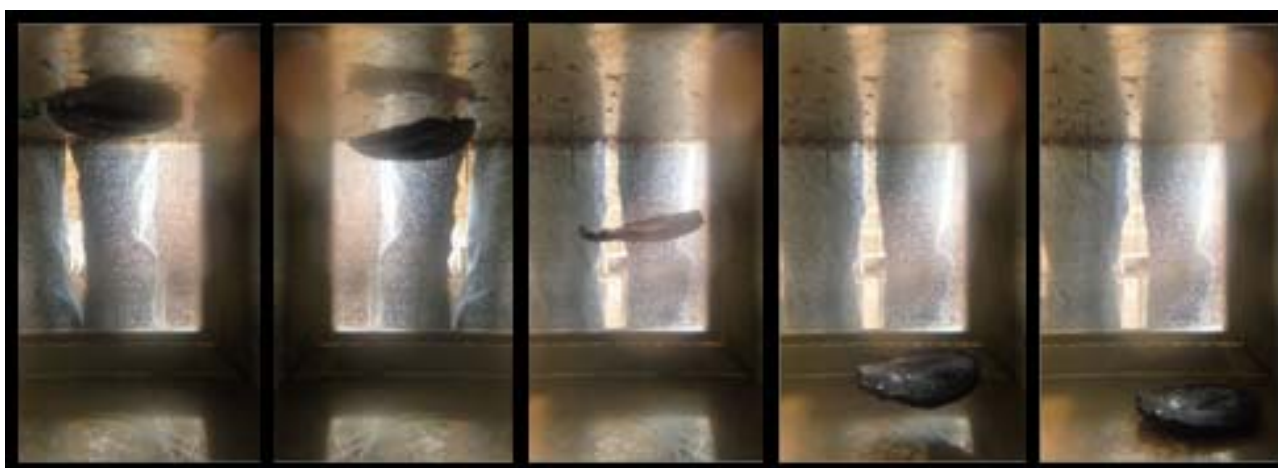
Figur 4.1. Nedsynkning af afbrændingsrester efter afbrændingseksperimenter foretaget i laboratoriet (fra Fritt-Rasmussen et al. 2016)
