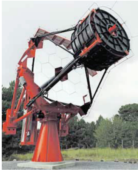
Protótipo italiano de telescópio de 4 m do projeto CTA: FAPESP financia a construção de três unidades, com participação de engenheiros brasileiros
