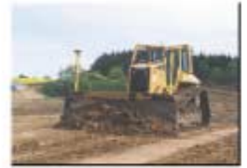
Caterpillar Raupe D6N mit installiertem SiteVision GPS.
