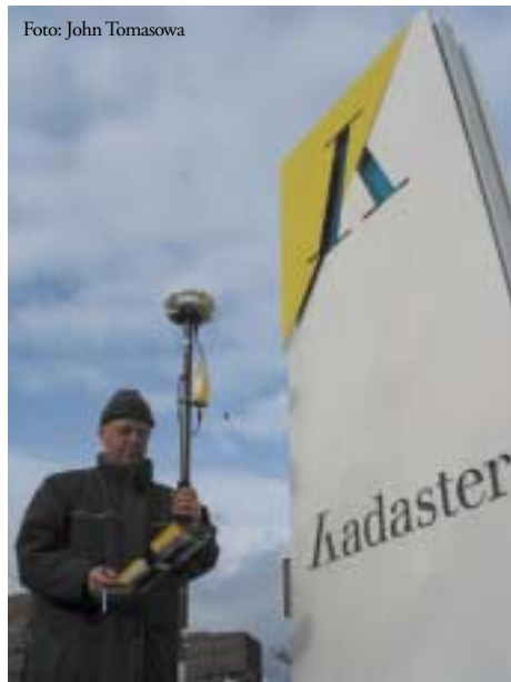
Die vom niederländischen Katasteramt erworbene Ausrüstung verfügt über GSM-Technologie für den Zugriff auf das Echtzeit-kinematische GPS-Netz 06GPS - das wichtigste Referenznetz in den Niederlanden.
