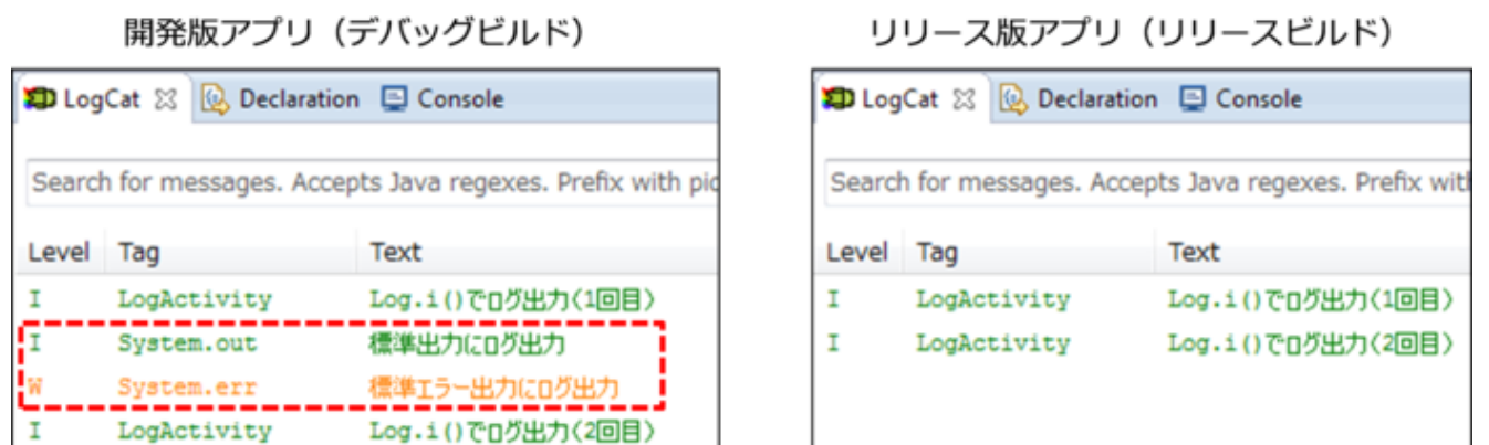
図 4.8.3 System.out/err の開発版アプリとリリース版アプリの LogCat 出力の違い
