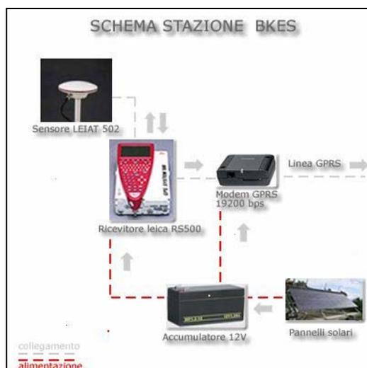
**Fig. 5:** Schema dell'implementazione della stazione BKES, situata, sul Gran Cono vesuviano, a circa 900 metri di quota. Sono rappresentati l'antenna LEIAT502, il ricevitore RS500, il modem GPRS da 19200 bps, l'accumalore 12V ed i pannelli solari.
