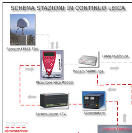
**Fig. 4:** Schema tipo di una stazione attrezzata con strumentazione Leica. Sono rappresentati l'antenna LEIAT504, i ricevitore RS500, il modem da 56000 bps, l'accumulatore da 12V e l'alimentatore.
