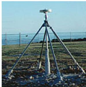
**Fig. 9:** Monumentazione tipo *Deep Drill-Braced* (foto tratta dal sito della Central Washington University, <http://www.geodesy.cwu.edu>).
