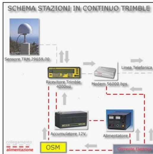
**Fig. 7:** Schema esemplificativo di una stazione attrezzata con strumentazione Trimble. Sono rappresentati l'antenna TRM29659.00, il ricevitore 4000SSI, il modem da 56000 bps, l'accumulatore da 12V e l'alimentatore.
