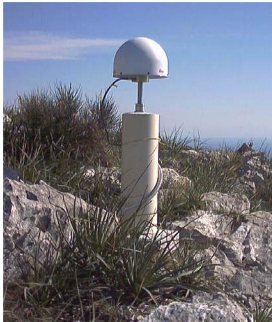
**Fig. 13:** *Monumentazione della stazione ENAV, sono visibili il pilastro su cui è fissato il caposaldo, il raccordo caposaldo-antenna e l'antenna choke ring LEIAT504 dotata di copertura (Radome).*
