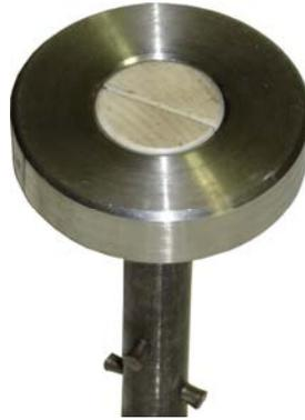
**Fig. 12:** *Caposaldo standard della rete CGPS dell'area vulcanica napoletana.*
