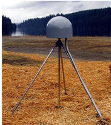
**Fig. 8:** Monumentazione tipo *Short Drill-Braced* (foto tratta dal sito della Central Washington University, <http://www.geodesy.cwu.edu>).
