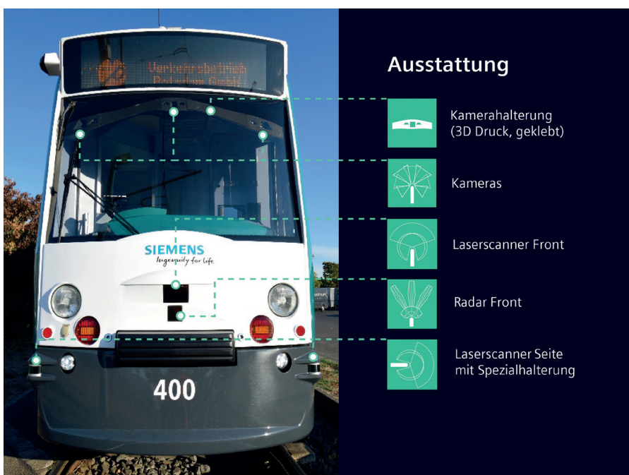
Bild 6: Combino von Siemens Mobility mit Ausrüstung zur Hinderniserkennung
