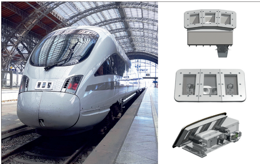
Bild 5: Sensorbox, mit der Sensoren für eine Hinderniserkennung nachträglich in Bestandsfahrzeuge integriert werden können
