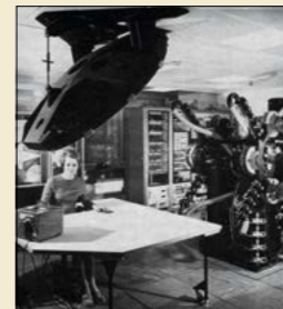
A view of a Lecteur à Spirale Digitisée LSD measuring machine (Spiral Reader). (Image credit: CERN 721.1.69.)
