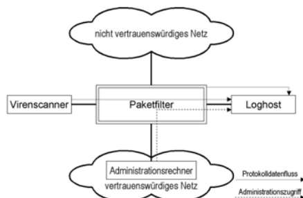
Abbildung 2: Platzierung des Loghost bei einfach strukturierten Sicherheitsgateways
