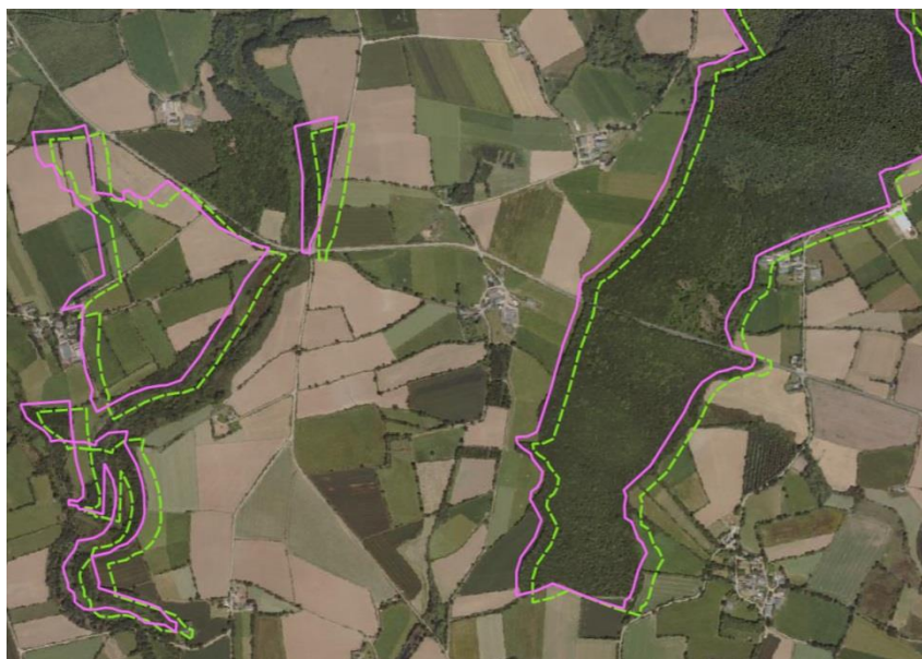
Figure 27 : en vert, la digitalisation de forêts réalisée sur le SCAN Historique (Niveau 3) - en violet, la digitalisation bénéficiant de la grille de transformation. La saisie s'est rapprochée de la forêt existante en se traduisant de quelques mètres.
