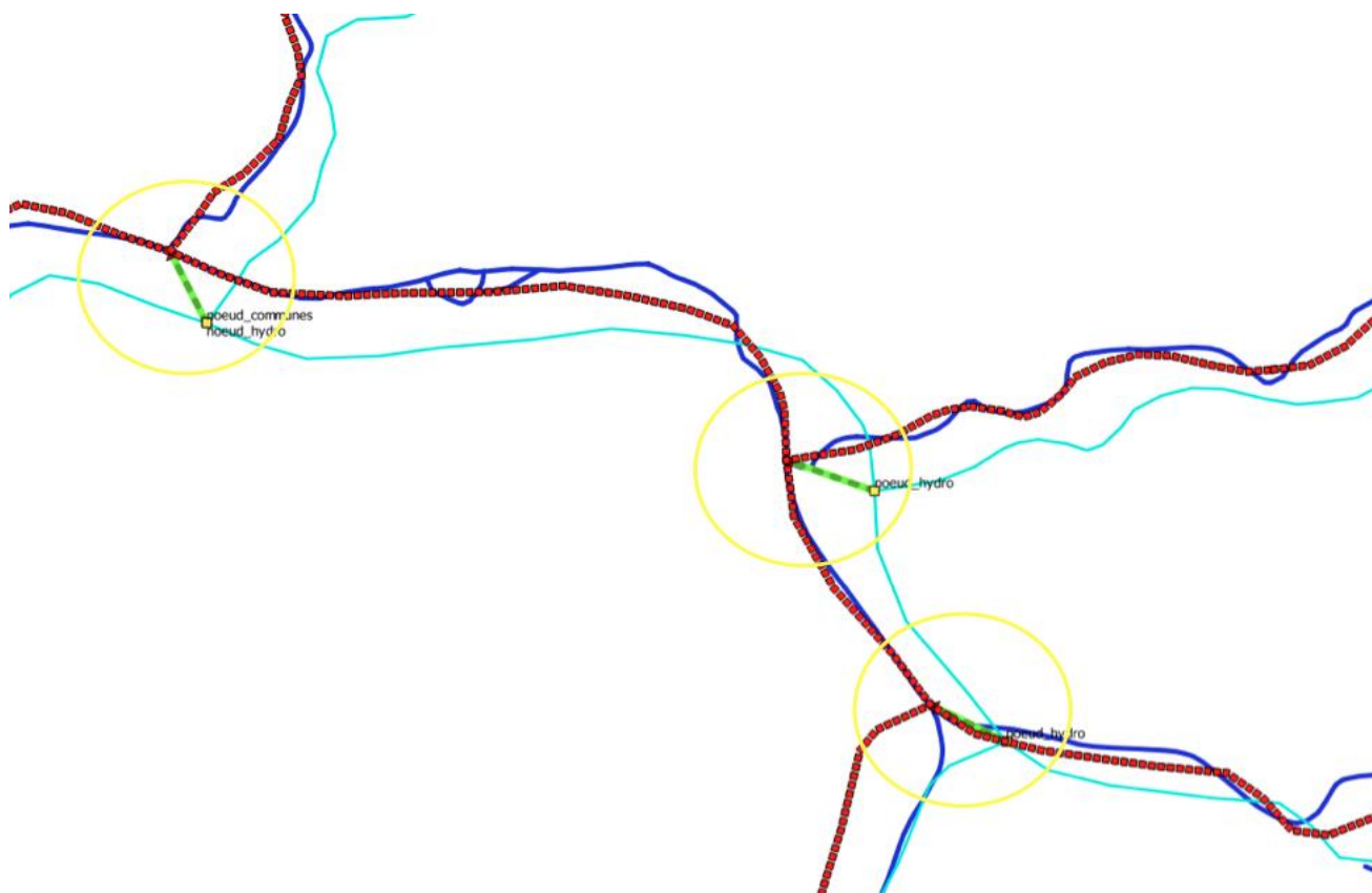
Figure 32 : recalage du réseau hydrographique – résultat de la déformation (trait rouge) – hydro ancien (bleu clair) – hydro actuel BDTopo® (bleu foncé). Suite à la déformation, on constate que l'hydro ancien passe maintenant parfaitement sur les nœuds des carrefours hydrographiques (cercle jaune).
