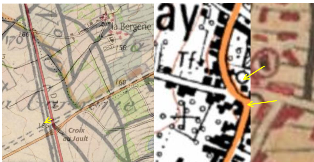
Figure 11 : aperçus des décalages (réseaux routiers, clochers,...) entre le SCAN EM® 40k (référentiel ancien) et le SCAN 25 (référentiel actuel)
