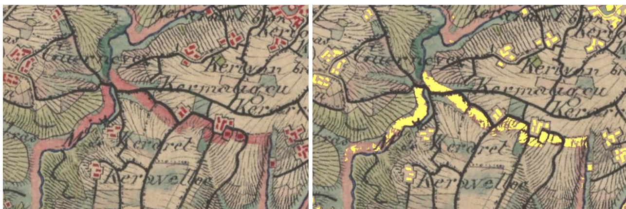
Figure 59 : aperçu d'une extraction incriminante issue d'une confusion entre le rouge bâti et le rouge des limites communales ou d'arrondissements. À nettoyer !
