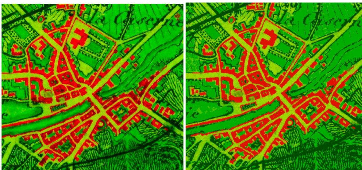
Figure 56 : (à gauche) image en sortie de photoshop avant le lancement du k-means. On peut distinguer clairement du rouge clair et du rouge foncé. (À droite) image après le traitement k-means. L'image est réduite à 5 classes de couleurs, dont le rouge.
