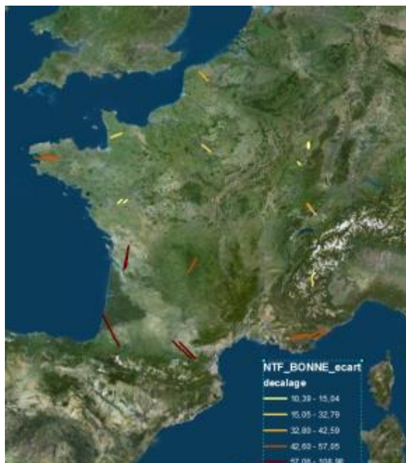
Figure 21 : matérialisation des vecteurs d'écart France entière entre le système ATIG et NTF - accentués 1000 fois- un écart de 10m est représenté par un segment de 10km sur la carte
