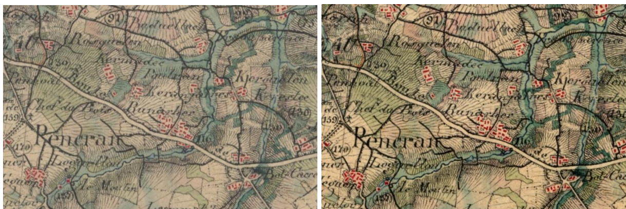
Figure 76 : (image de gauche) SCAN état-major brute issue du Géoportail, (image droite) même image avec un prétraitement automatique sur le contraste
