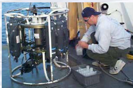
Un CTD se une a una estructura metálica llamada carrusel, junto con numerosas botellas de muestreo de agua y cuando se despliega, proporciona información sobre la composición de la columna de agua. Imagen: NOAA.
