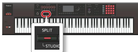
スプリット画面が表示されます。鍵盤右手側はアッパー・トーン、鍵盤左手側はロワー・トーンが鳴ります。
