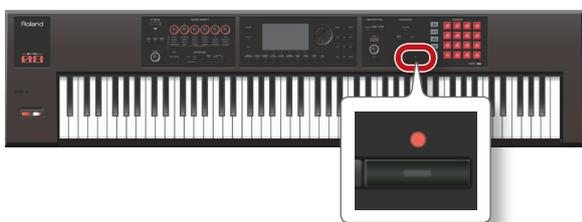
[●] ボタンが点滅し、録音待機状態になります。Realtime Rec Standby ウィンドウが表示されます。
