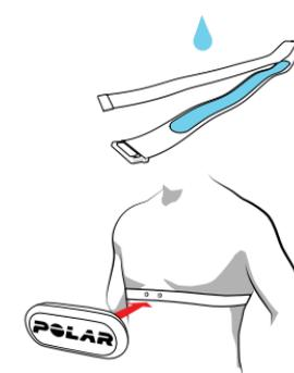
**i** 训练后，拆下心率传感器连接器，并在流动水下冲洗以保持干净。有关更详细的说明，请参阅 V650 支持页面 [support.polar.com/zh-hans/V650](http://support.polar.com/zh-hans/V650)。
